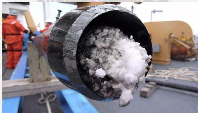
Gráfico 20 Remoción de un tapón de hidrato de gas natural
