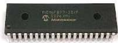
Figura 2: Microcontrolador PIC 16F877A
