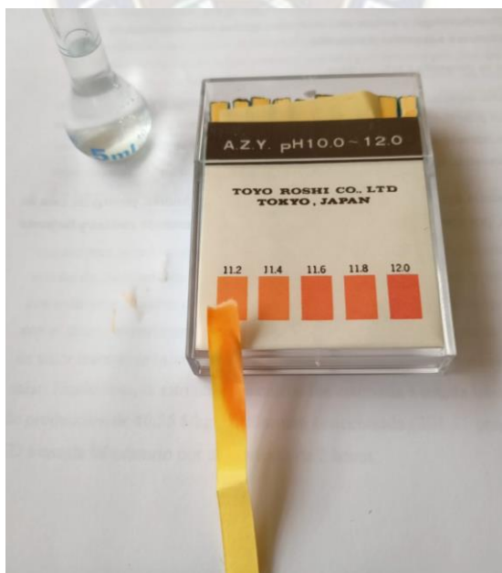
Figura 25 Resultados de pH medido en la solución del material precipitado
