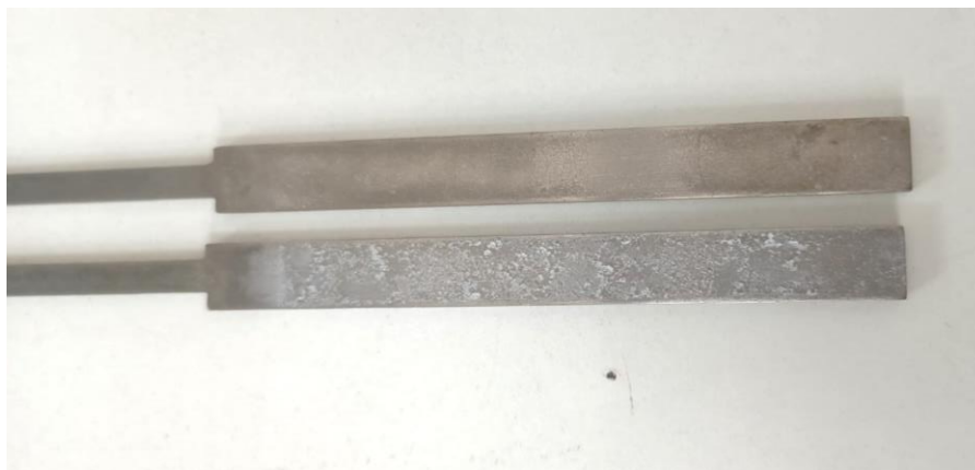
Figura 24 Electrodo catódicos con material precipitado
