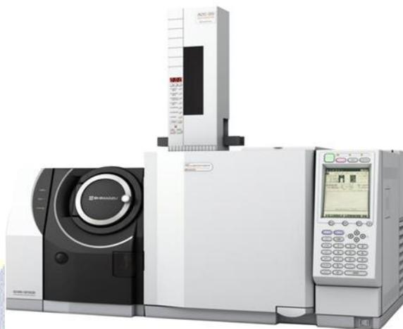
figura 13. Equipo utilizado de Cromatografía de gases Acoplado al espectrómetro de masas marca Shimadzu CGMS—QP2020
