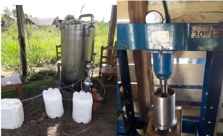
Figura 12 Equipo destilador por arrastre de vapor y prensa hidráulica para extracción de aceites esenciales, hidrolatos y aceites vegetales.
