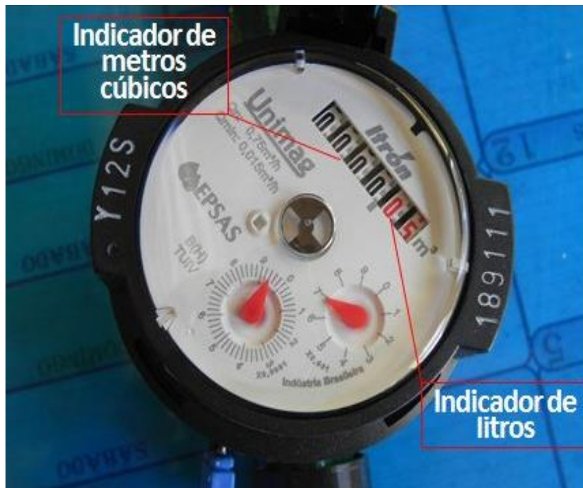
Ilustración 3 Medidor de Agua
