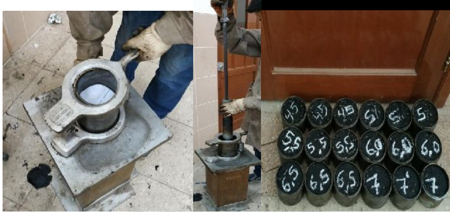
Figura 46: Elaboración de Briquetas
