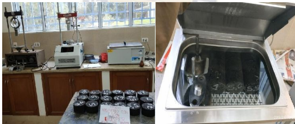
Figura 50: Estabilidad y Fluencia
