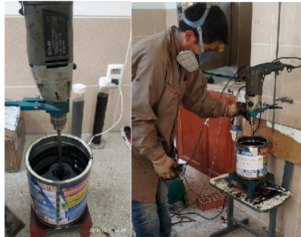
Figura 63: Proceso de Modificación del Asfalto Convencional con Modificante
