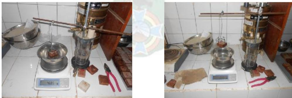
Foto 4.11 Sistema creado para la determinación del volumen de la probeta.
