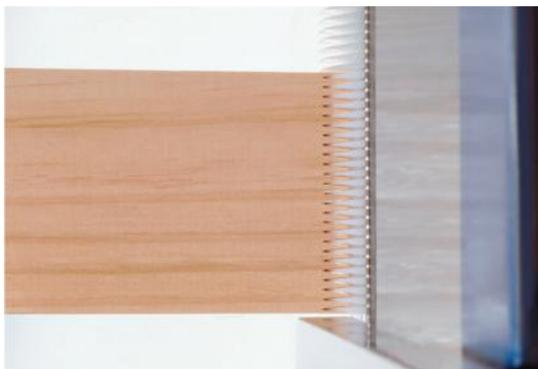
Figura 2.3 Corte con maquinaria (sistema de empalme Finger Joint)
