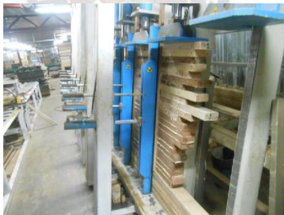
Foto 4.23 Prensado de las probetas.
