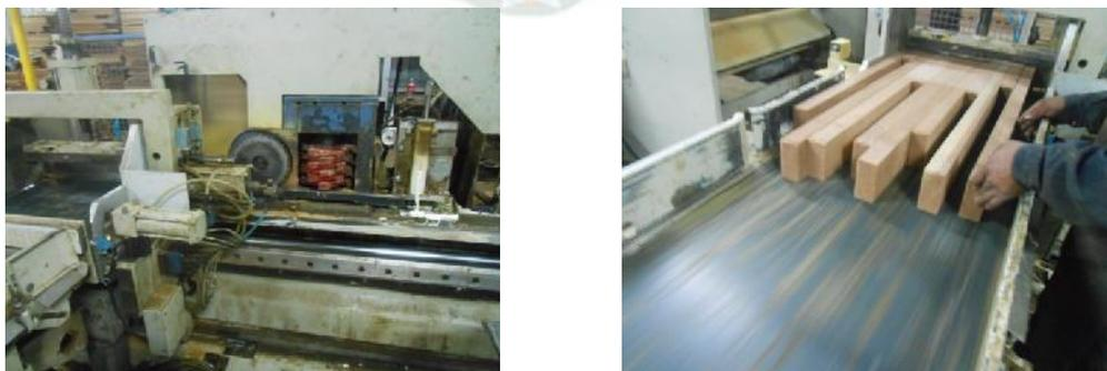
Foto 4.15 Corte transversal de las piezas en la máquina Finger.
