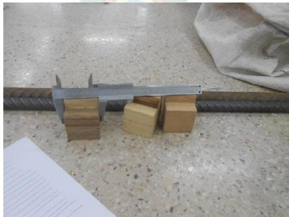
Foto 4.34 Muestras extraídas de las probetas para el ensayo a corte en la línea del adhesivo.
