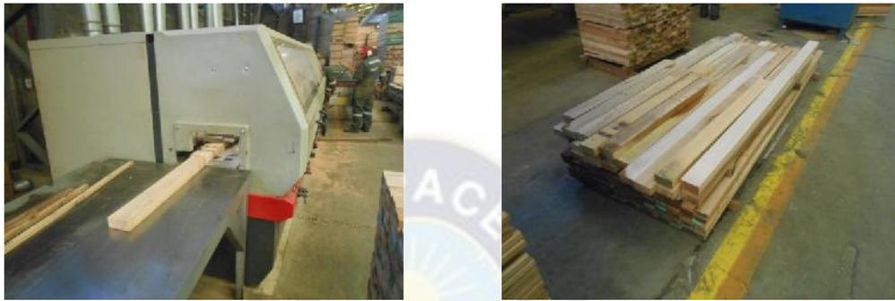
Foto 4.12 Moldurado de las láminas.
