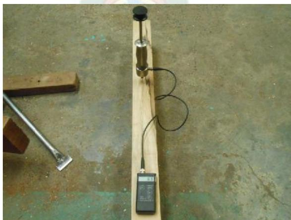
Foto 4.6 Instrumento para la medición de humedad en las maderas.
