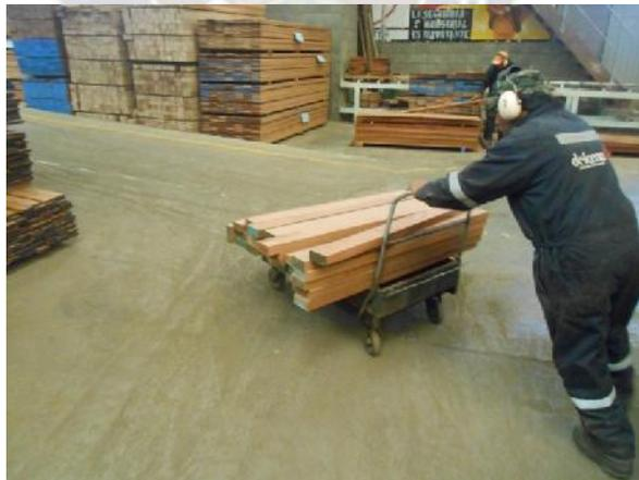
Foto 4.4 Acarreo de las piezas de madera al horno para su secado.
