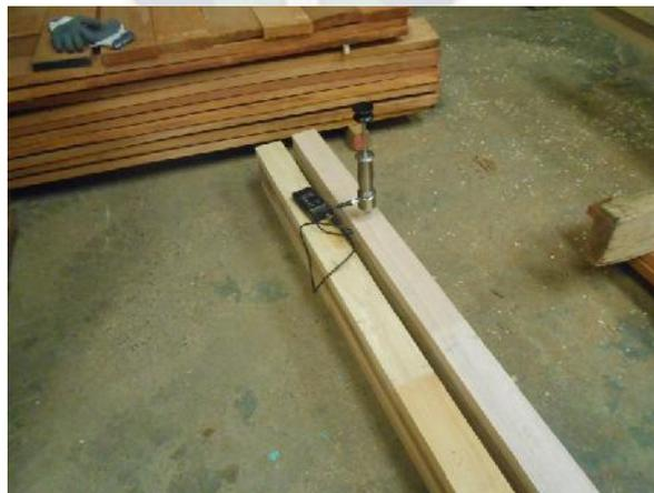
Foto 4.30 Medición del contenido de humedad de las probetas.
