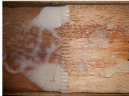
Foto 4.20 Producto final del encolado de la junta transversal.
