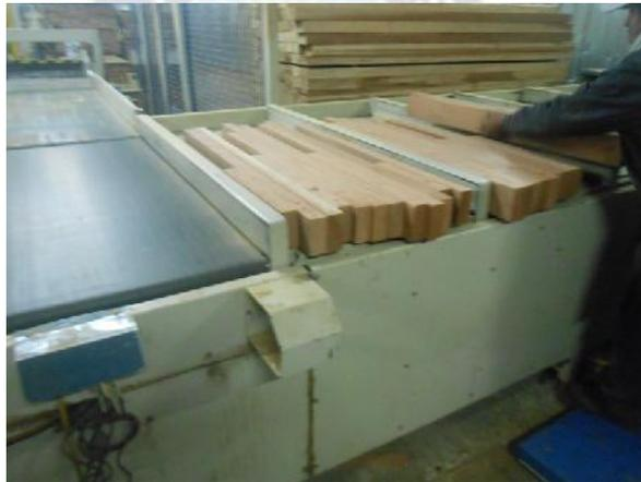
Foto 4.14 Recepción de láminas de madera para el corte Finger (Casillas que restringen la longitud de dichas láminas).
