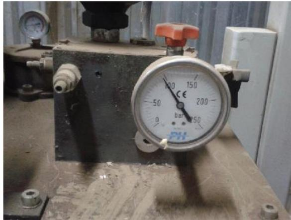
Foto 4.22 Manómetro de la maquina prensadora.
