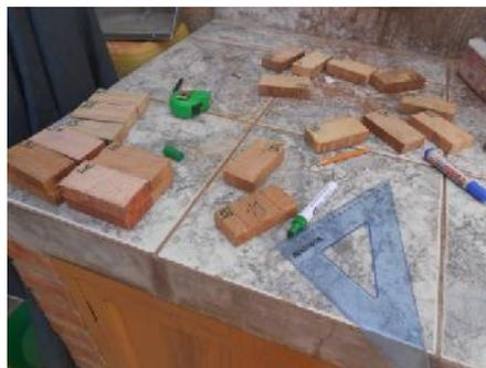
Foto 4.8 Corte de la sección de las probetas.
