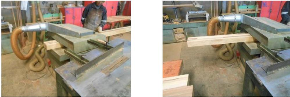
Foto 4.28 Cepillado de las probetas.
