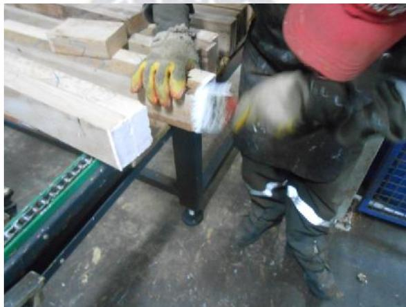
Foto 4.16 Colocado del adhesivo en las juntas de forma manual.
