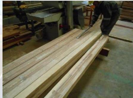
Foto 4.27 Enumerado de las probetas y limpieza previa de los bordes.
