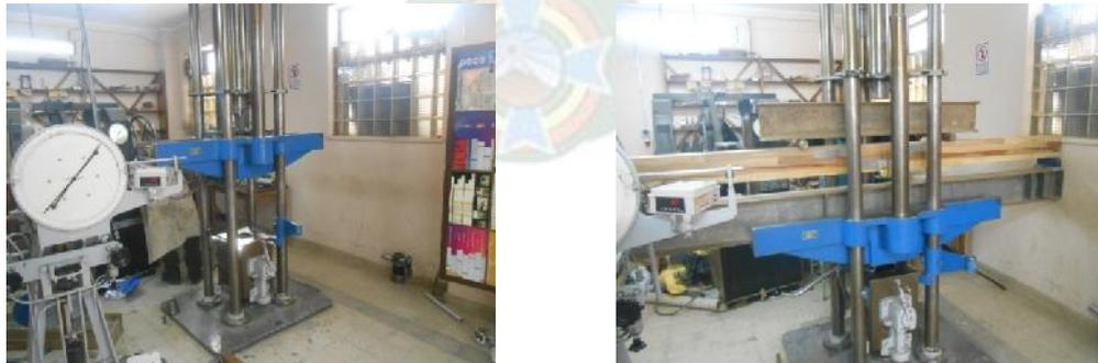
Foto 4.32 Prensa Universal para el ensayo a flexión simple y adaptada para la luz de las probetas.
