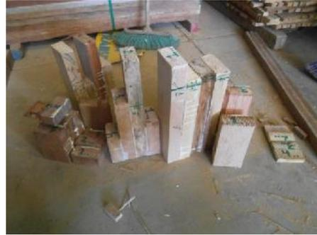
Foto 4.26 Corte transversal de las probetas y secciones cortadas de las probetas.
