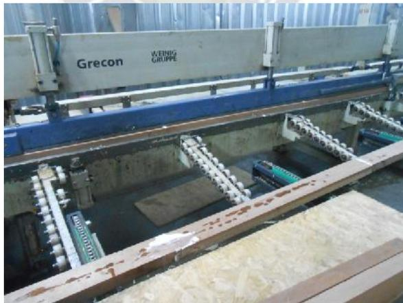
Foto 4.19 Prensado longitudinal para el encolado de las diferentes juntas.
