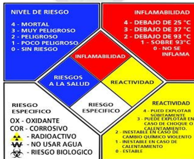
Figura 4.19 Información de Sustancias Peligrosas
