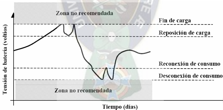
Figura 2.8 Comportamiento de carga con regulador.
