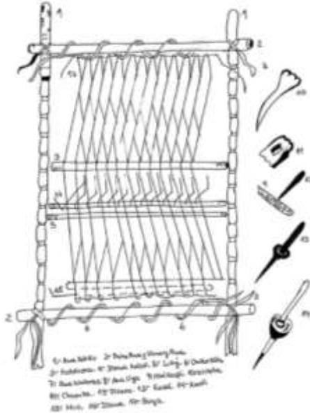
**Figura 120.** Instrumentos del Telar. Elaboración propia.
