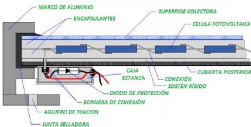
Figura 15: Componentes de un panel fotovoltaico.
