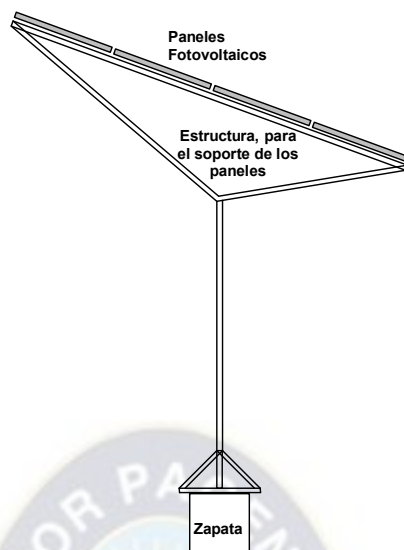
Figura 27. Estructura Utilizada, para el soporte para el sistema solar fotovoltaico.
