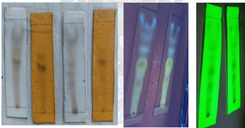
Figura 8 Cromatografía en capa fina del hidrolizado tratado con ácido sulfúrico
