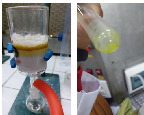
Figura 10 Cromatografía líquida de vacío del extracto hidrolizado
