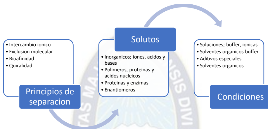
Ilustración 14 Principios de separación en HPLC
