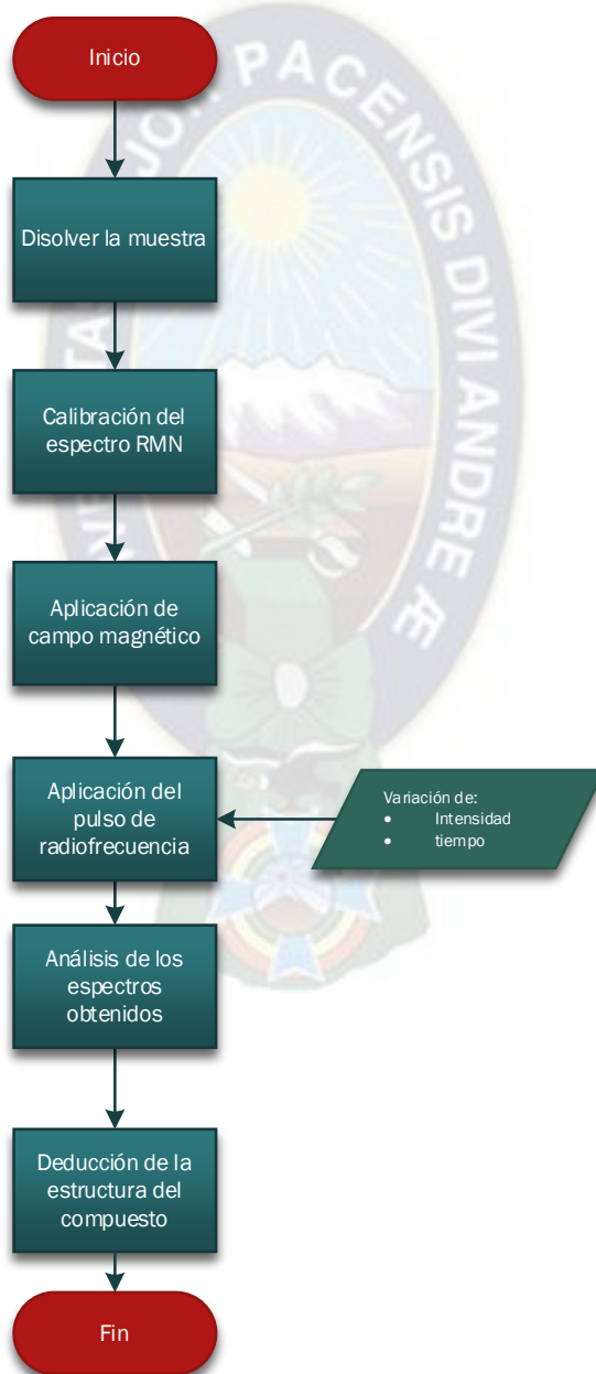
Ilustración 28 Proceso de resonancia magnética nuclear
