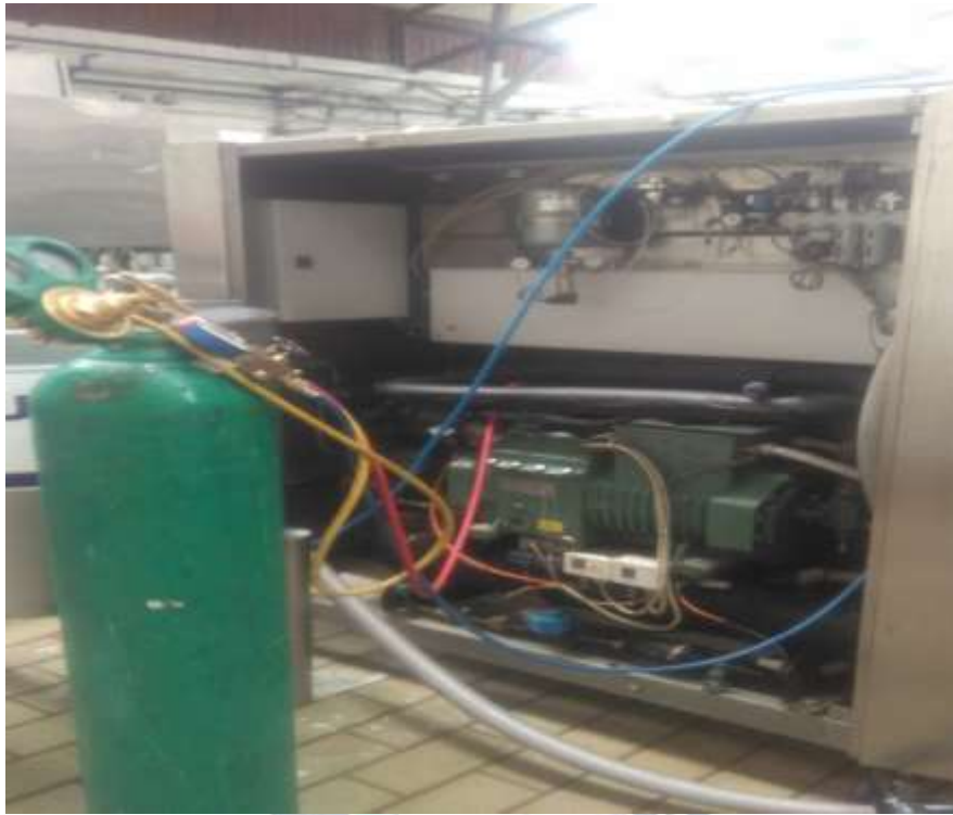
Anexo 9. Mantenimiento a freezer dosificador de helado de crema
