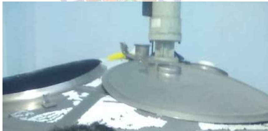
Fotografía 16. Abertura para el llenado de leche y motor del batidor Fuente. Elaboración propia
