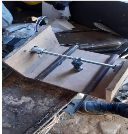
Figura N° 40. estructura con rieles motor pasa a paso
