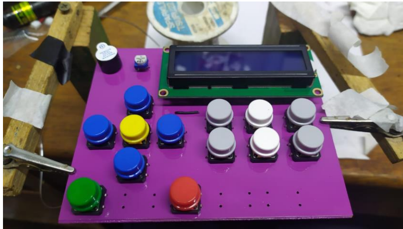
Figura N° 48. Botonera de control manual
