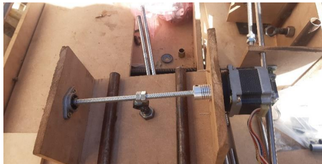
Figura N° 39. armada de rieles y carriles
