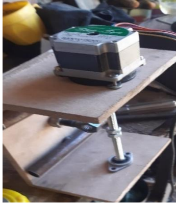
Figura N° 42. Motor dc 2.5 voltios en funcionamiento y 1.8 grados
