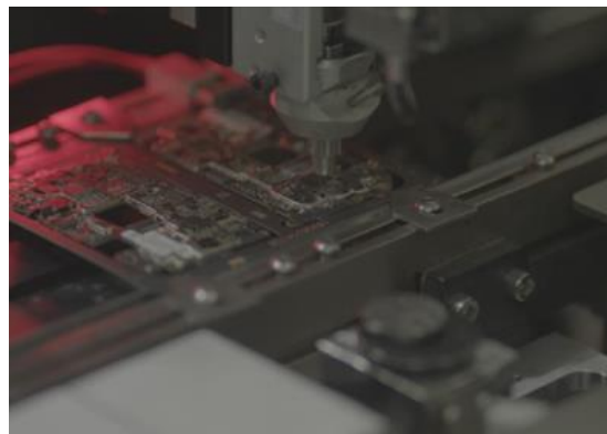
Figura Nº 9. Fabricación del circuito de los audífonos
