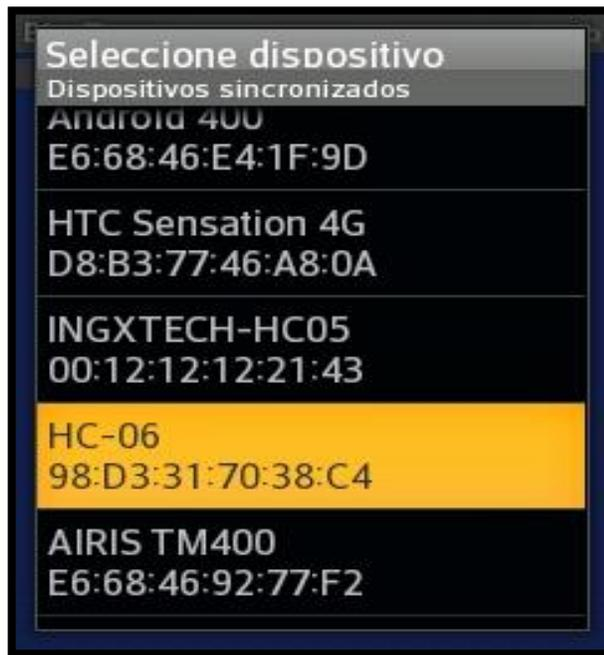
**Figura 34.** Selección del dispositivo móvil con el Módulo bluetooth HC-06.
