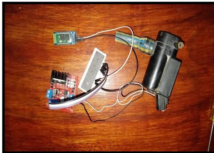
**Figura:** PIC16F877A conectado al Módulo Bomba de Agua y al Módulo Bluetooth.
