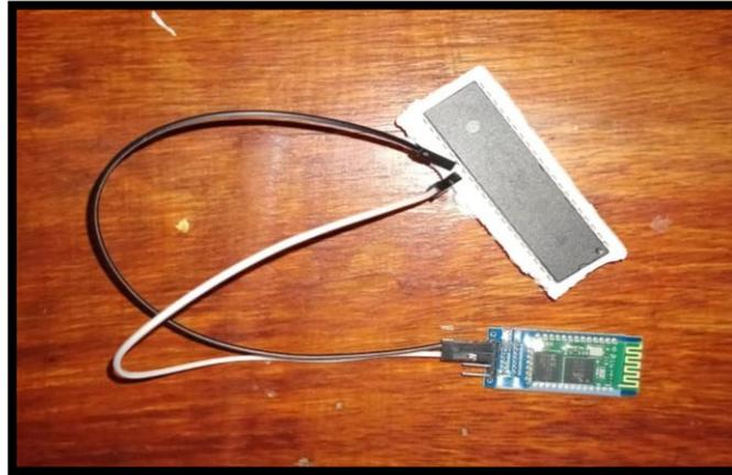
**Figura:** PIC16F877A conectado al Módulo Bluetooth.
