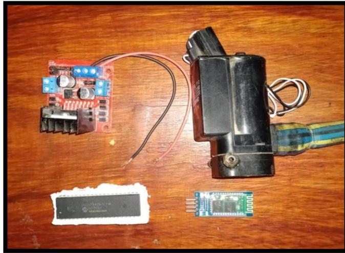
**Figura:** Microcontrolador PIC16F877A, Modulo Bomba de Agua, Puente H L298N,
