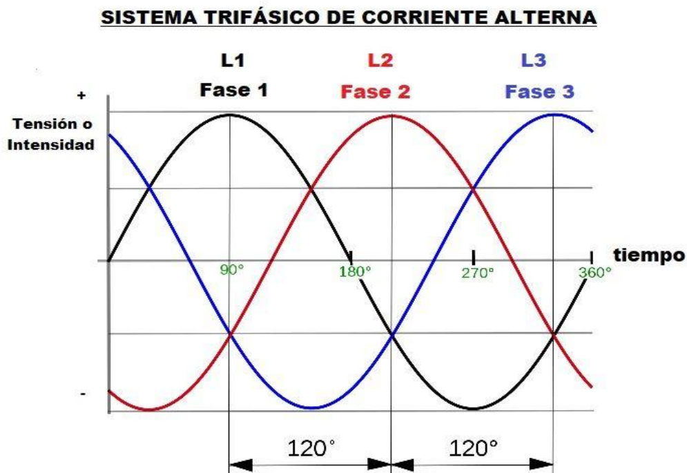
Figura 12. Representación de onda sinusoidal en sistema trifásico
