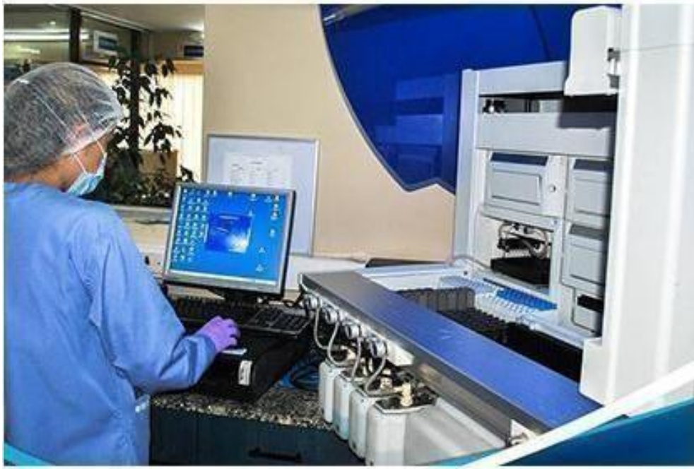
Figura 7. Equipo DSX, totalmente automatizado con cuatro platos Elisa y capacidad para realizar ensayos múltiples por plato.
