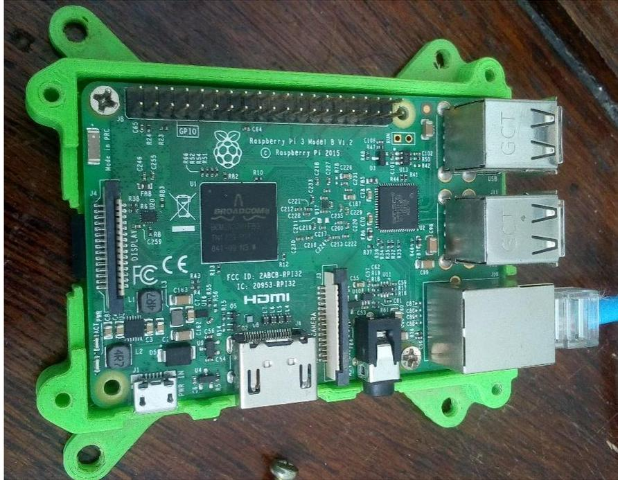
Figura 12.Raspberry PI 3 modelo B.
