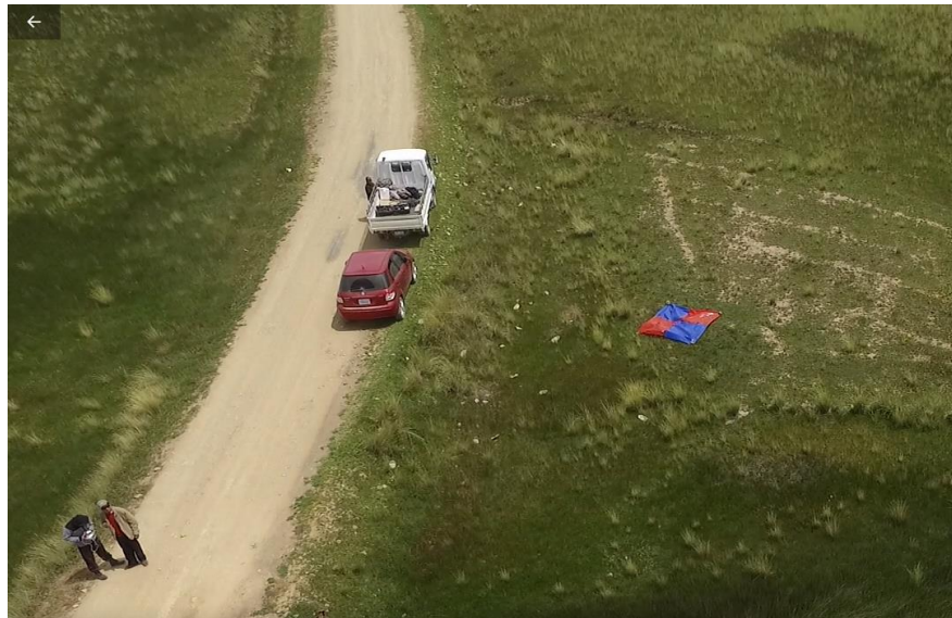
Imagen 3. Lona de color rojo y azul para la toma de puntos de control.
