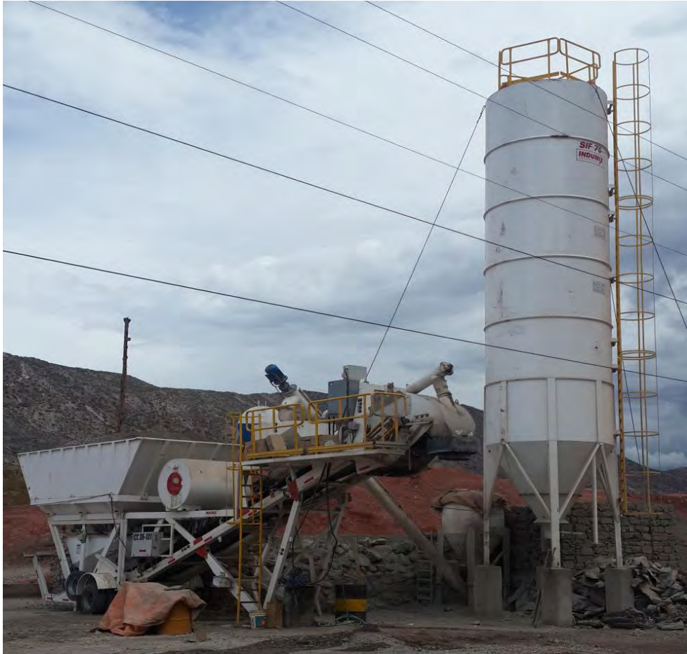
Planta Dosificadora de Hormigón
