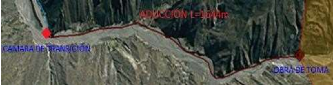
Figura 7. Ubicación y longitud de aducción.
