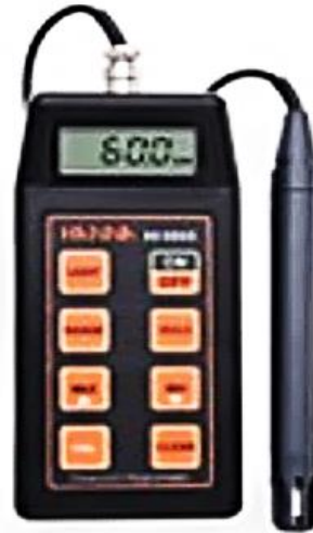
Figura 12. Higrometro HANNA para medir temperatura y humedad
