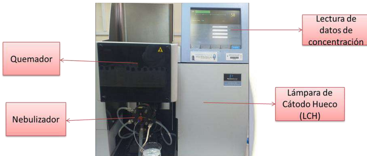
Figura 17. Espectrofotómetro de absorción atómica FAAS (Analyst 200)
