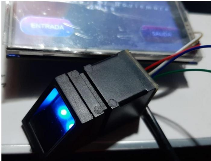
Figura 39 Detector de huella dactilar en funcionamiento
