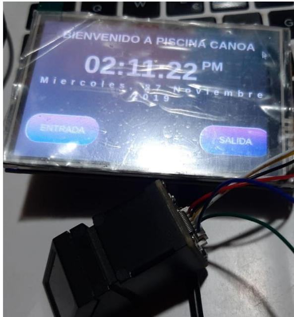
Figura 35 Inicio del programa en la Raspberry Pi y la pantalla XPT2046
