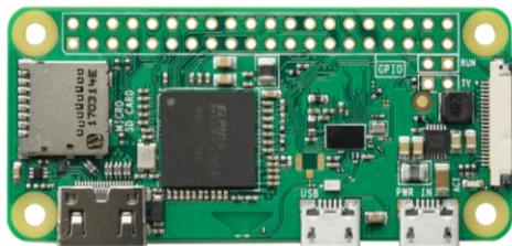
Figura 15: Raspberry Pi Zero W utilizada en el proyecto
