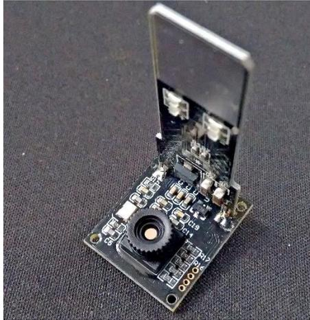
Figura 9 Circuito interno del sensor R307 (sensor de imagen y detector Touch Pad)
