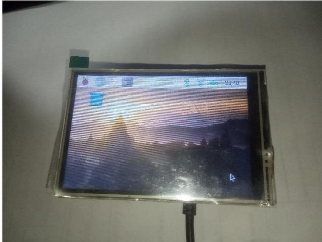
Figura 23: Pantalla XPT2046 con Sistema Operativo
