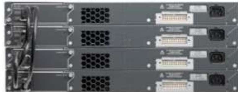
Figura 2. FlexStack-Plus en los switches Cisco Catalyst serie 2960-X
