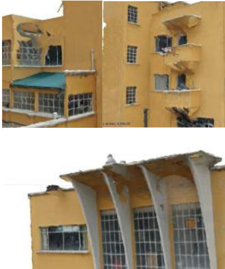
Errores en la consolidación de modelo fotogramétrico Fuente: Elaboración propia
