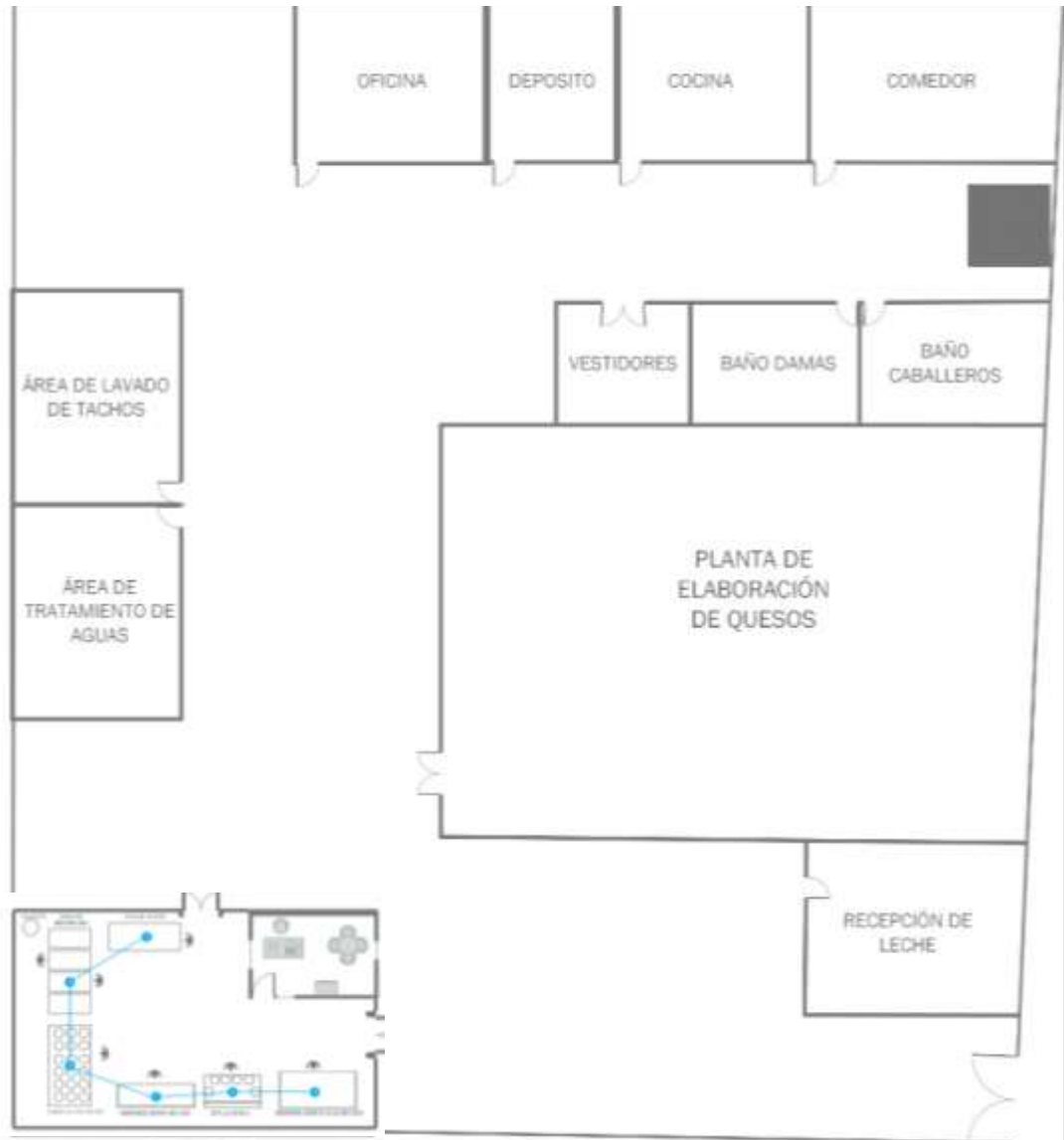
GRÁFICO N° 39: Ubicación de la nueva línea productiva en las instalaciones de la Planta Elaboradora de Quesos "San Mateo"
