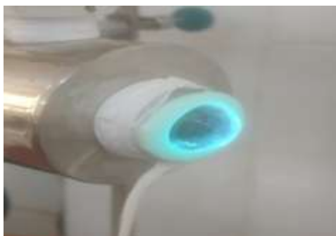
Figura 12. Componentes del sistema de tratamiento radiación ultravioleta. a) Sistema completo realizando el tratamiento de la matriz. b) Caudalímetro del sistema y c) Lámpara UV en la carcasa.
