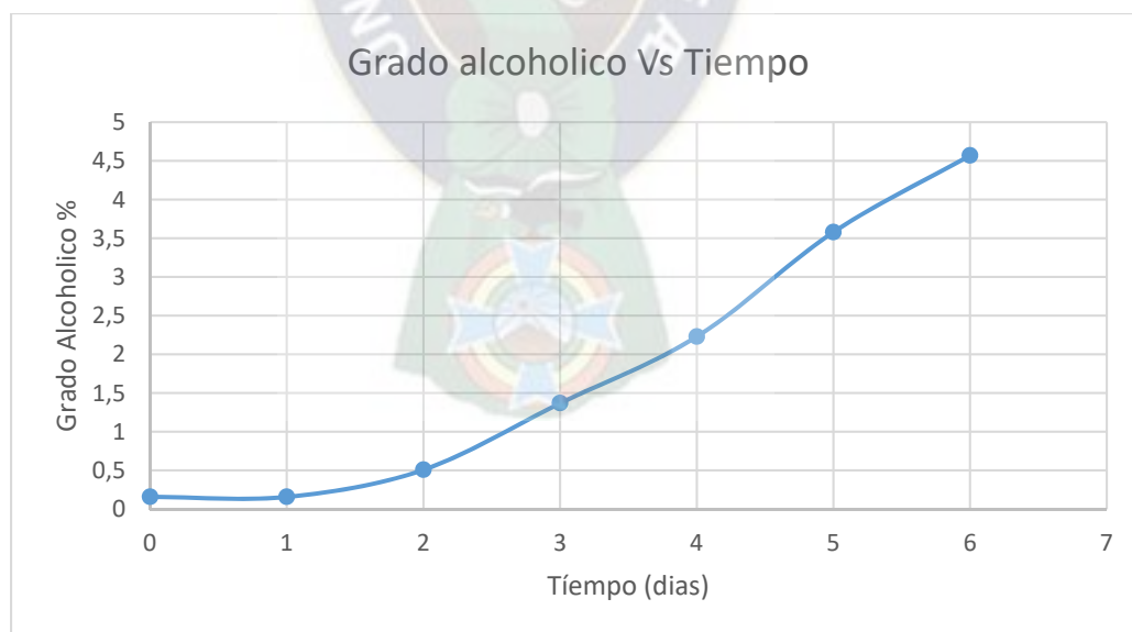
FIGURA 5.5 SEGUIMIENTO DEL GRADO ALCOHOLICO Vs TIEMPO
