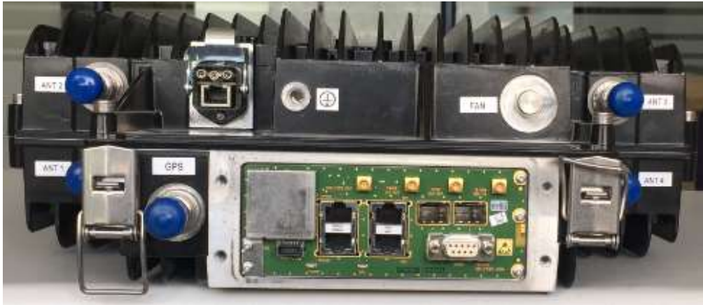
Figura 2-15: Detalle de los puertos de antenas y de transmisión
