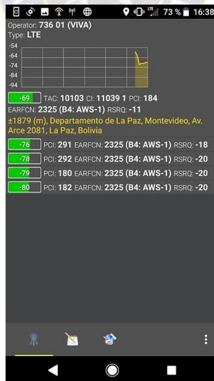
Figura N° 3.8 Localización de una radiobase 4G con Netmonitor.
