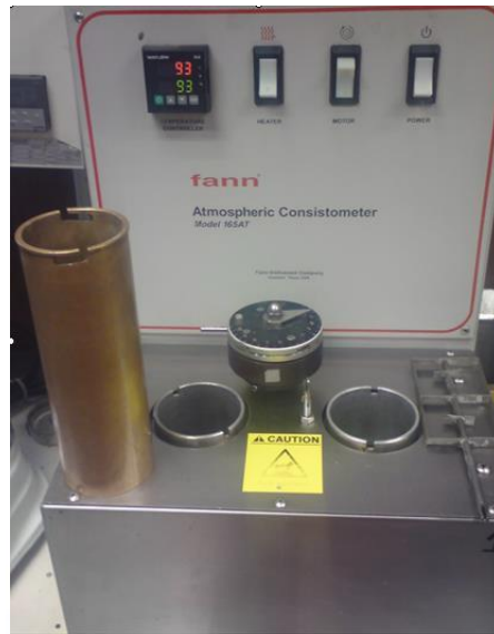
Figura 3. 10 Consistómetro atmosférico Fann modelo 165-AT.
