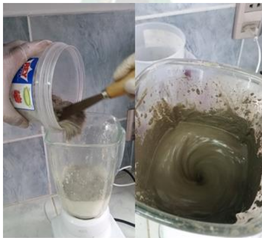
Figura 4. 5 Lechada de cemento homogénea con aditivos químicos.
