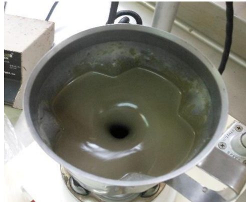
Figura 3. 4 Mezcladora Chandler con la lechada mezclándose > 12,000 rpm.
