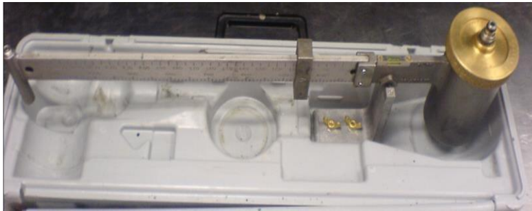
Figura 3. 6 Medición de la densidad en la Balanza de Lodos Presurizada.
