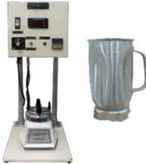
Figura 3. 3 Mezcladora Chandler con vaso de Mezclado.
