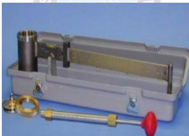
Figura 3. 5 Balanza presurizada para Lechadas de Cemento.
