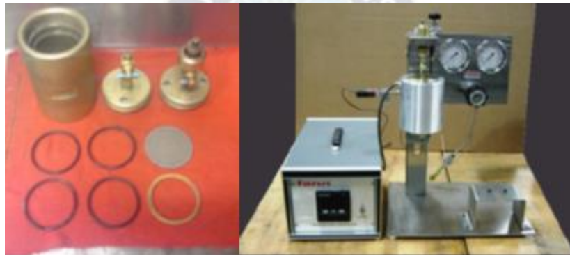
Figura 3. 13 Autoclave con accesorios (izquierda), filtro prensa Fann (derecha)
