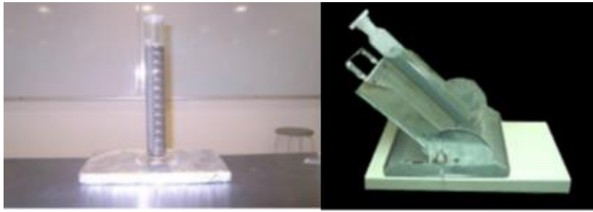
Figura 3. 7 Prueba de agua libre en pozos verticales y a 45°.
