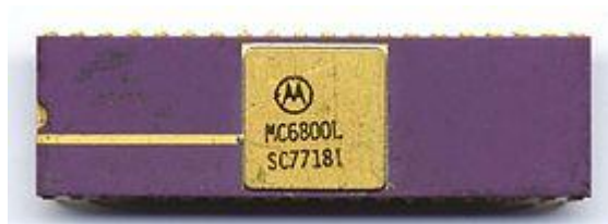
Figura 16: Microprocesador MC6800 de Motorola.
