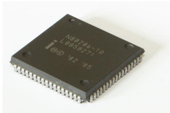
Figura 18: Microprocesador 80286 de Intel.
