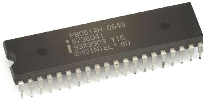
Figura 26: INTEL 8051 en empaque DIP 40.
