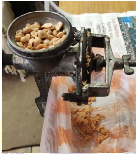
Figura 25: Proceso de Molienda del maní
