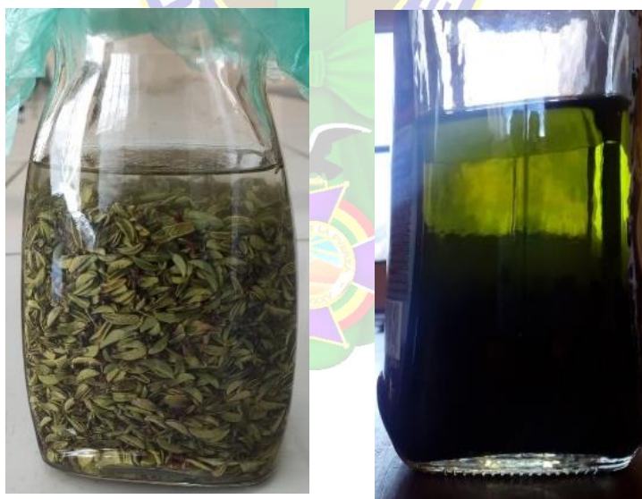
Figura 13: Proceso de extracción solido-líquido por maceración
