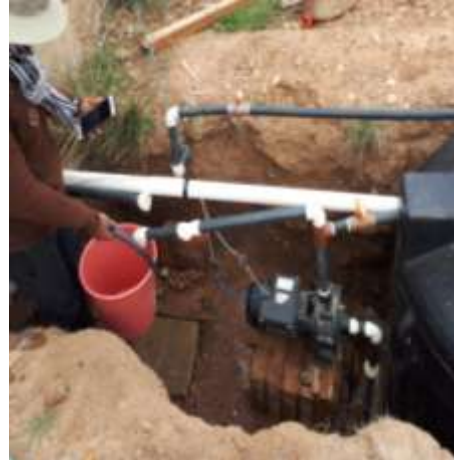
Figura 5. Medición del caudal por el método volumétrico.
