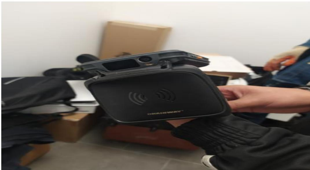
**Fotografía 20.** Visualización Escáner de RFID o lectores de RFID
