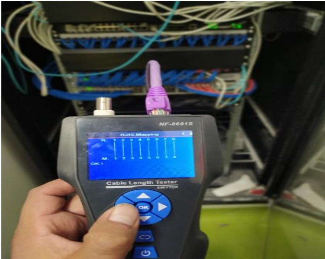
**Fotografía 33.** Visualización de la certificación del cable UTP
