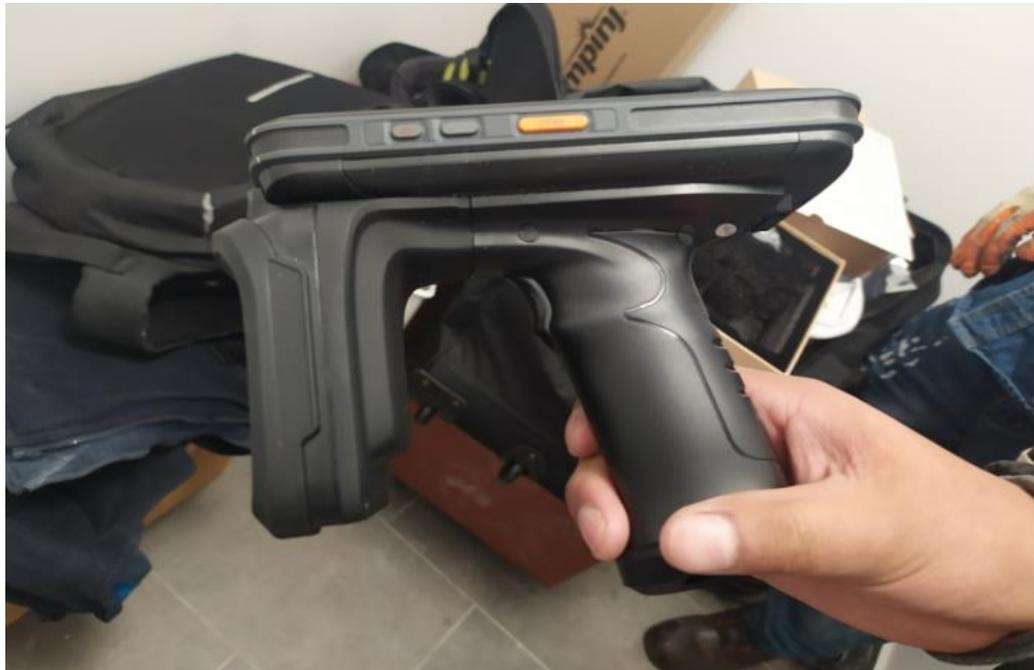
**Fotografía 19.** Visualización Escáner de RFID o lectores de RFID
