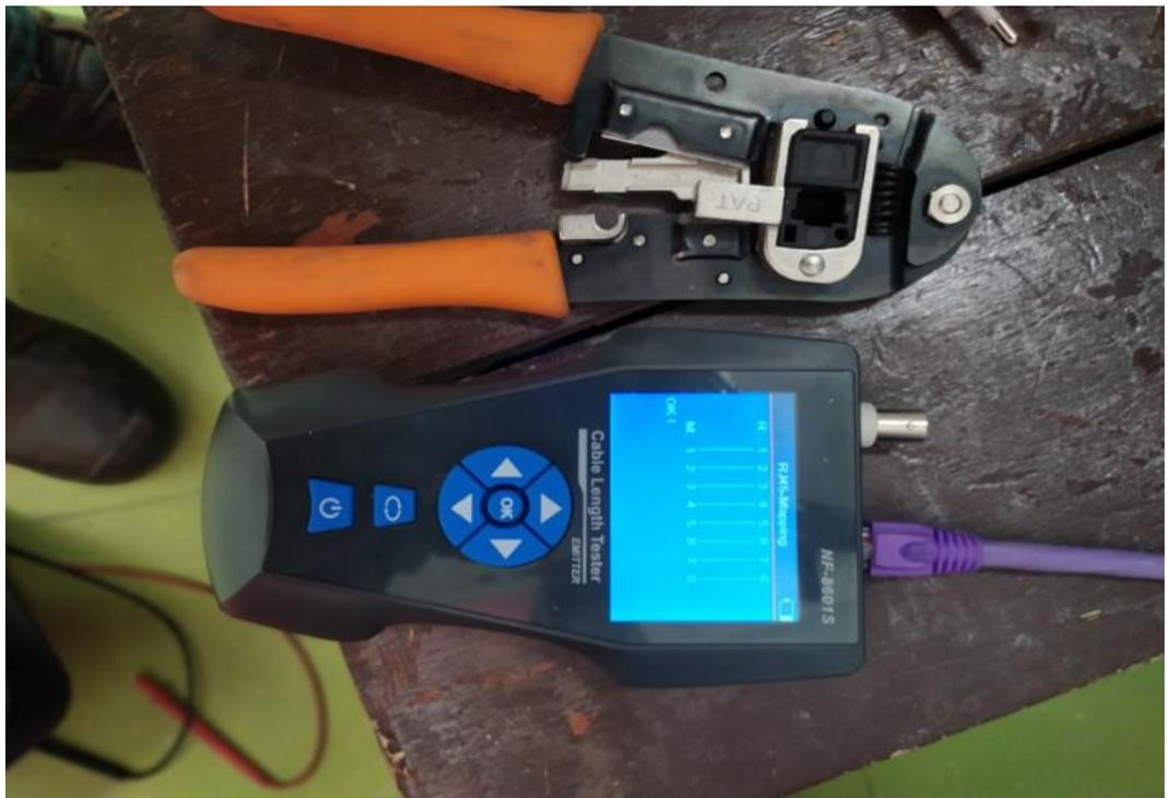
**Fotografía 32.** Visualización de la certificación del cable UTP
