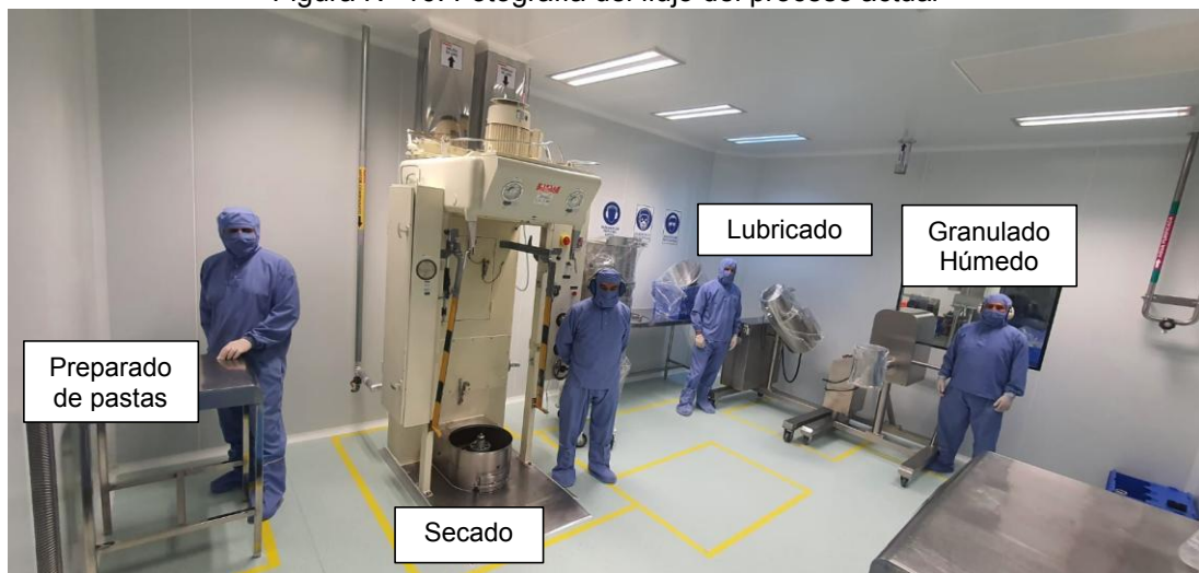
Figura N° 16: Fotografía del flujo del proceso actual
