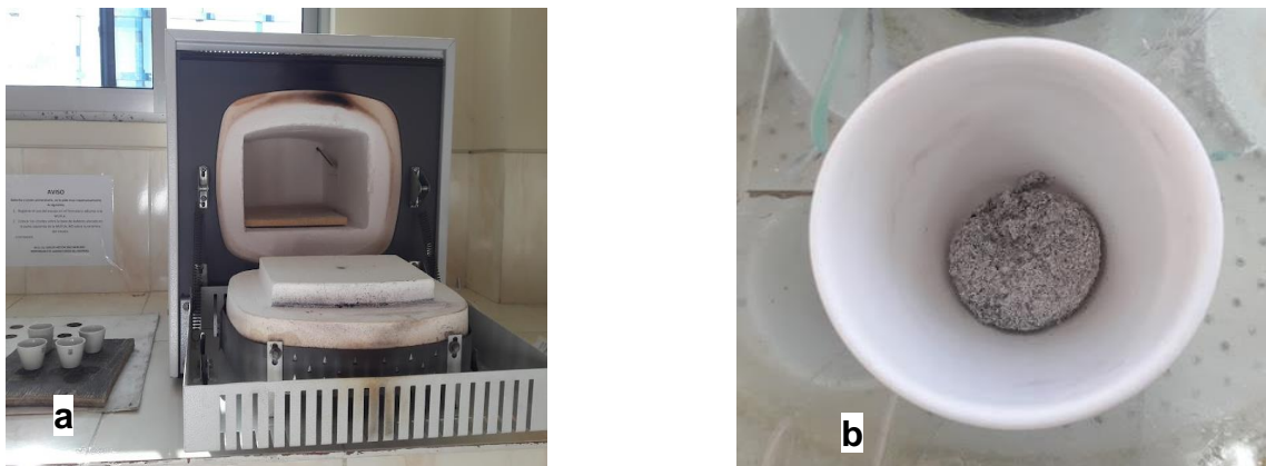
Foto 4: a) Retirado de crisoles de la mufla; b) Enfriado en el desecador
