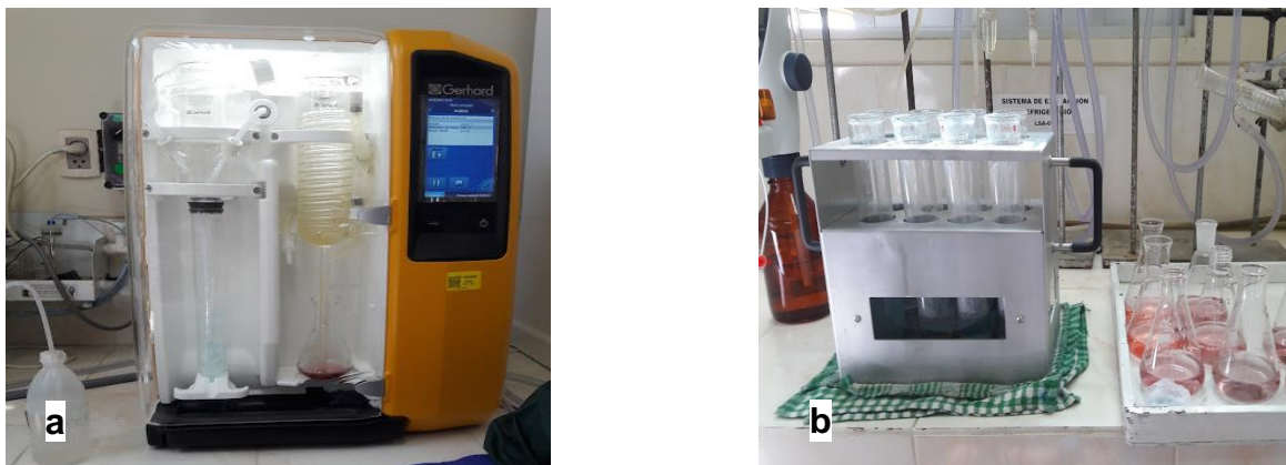
Foto 5: a) Destilación de la muestra; b) Titulación de las muestras
