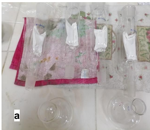
Foto 8: a) Colocado de la muestra en soxhlet; b) Proceso de extracción
