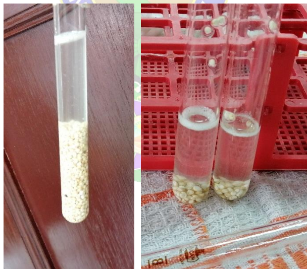
Figura 19. Determinación de la saponina de la quinua Fuente: Elaboración propia
