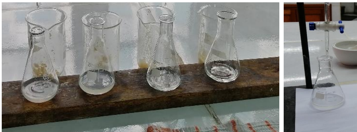
Figura 20. Determinación de la acidez de la quinua
