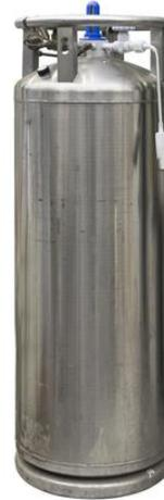
TANQUE DE NITRÓGENO
