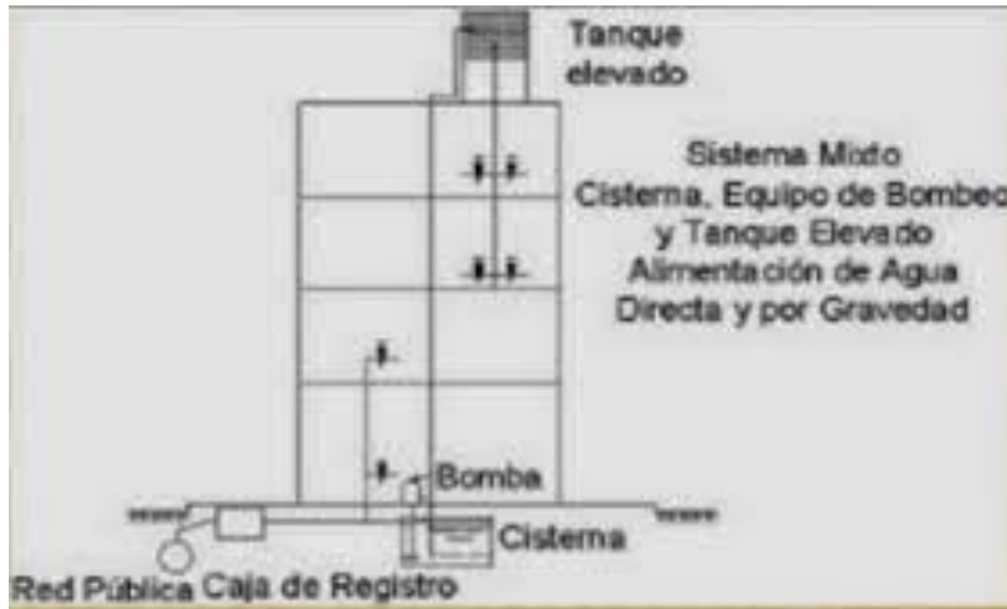
Figura N°6: sistema mixto de agua potable
