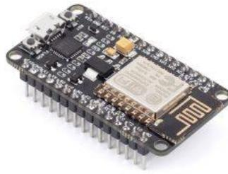
**Imagen5.10.** NodeMCU. Recuperado de <https://programarfacil.com/podcast/nodemcu-tutorial-paso-a-paso>
