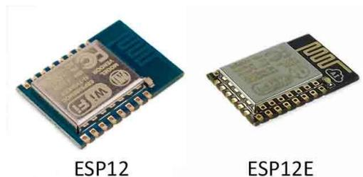
**Imagen 5.16.** ESP12 y ESP12E. Recuperado de <https://www.luisllamas.es/esp8266-nodemcu/>
