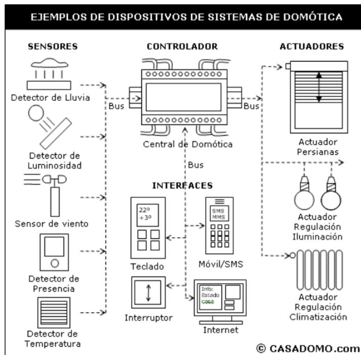
**Imagen 5.1.** Dispositivos de un sistema de domótica. Recuperado de Hernández B. R. Tecnología domótica para el control de una vivienda. 2012
