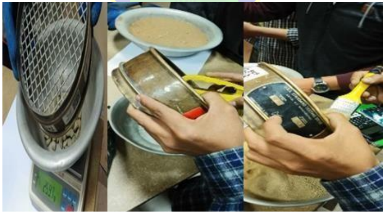
Representación gráfica del ensayo de granulometría
