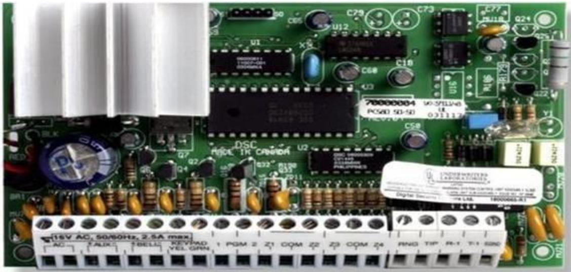
Figura 6: Central de Alarma y procesadora
