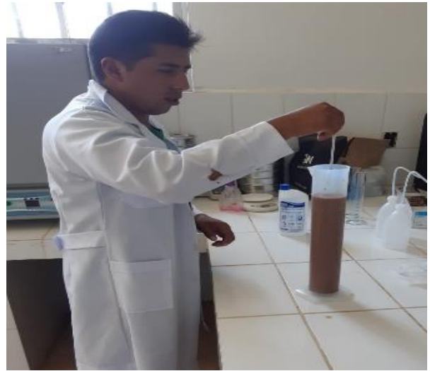
Determinación de la textura de las muestras de suelo por el método de Bouyoucos.
