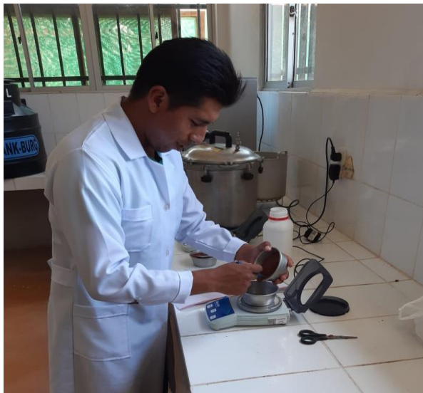
Determinación de la densidad aparente de las muestras de suelo.
