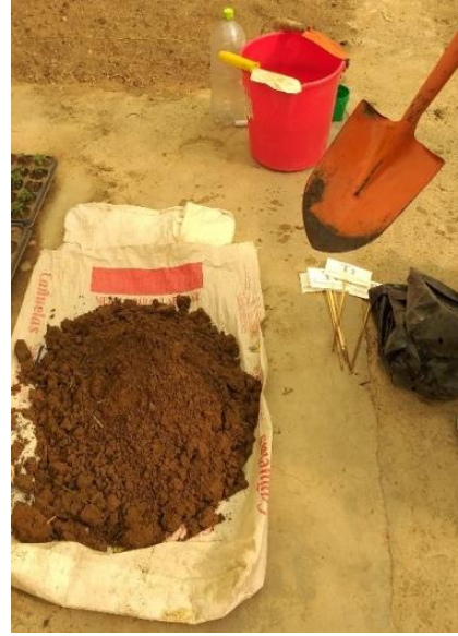
Figuras 8 y 9. Muestreo de los suelos por tratamiento para los diferentes análisis de laboratorio
