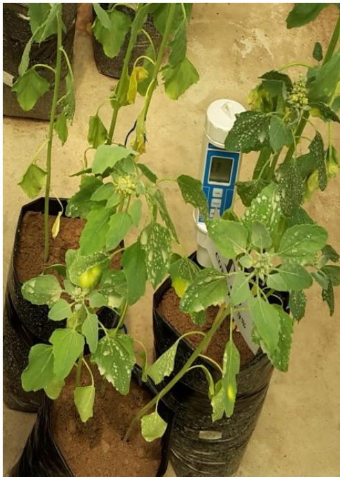
Figura 6. Medición de la humedad volumétrica directa al suelo de la maceta antes del riego
