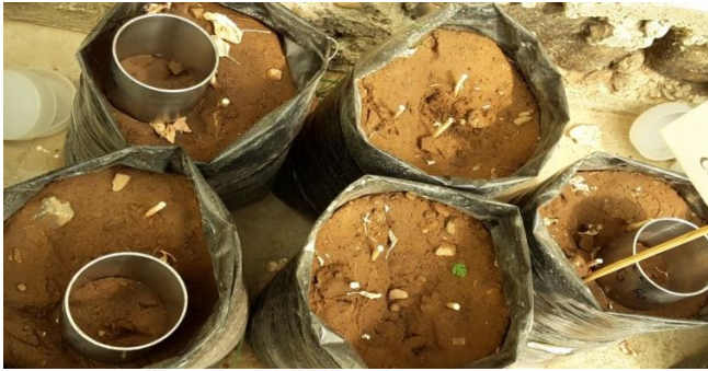
Figura 16. Muestreo de suelos en los cilindros (5x5) 3 muestras/tratamiento
