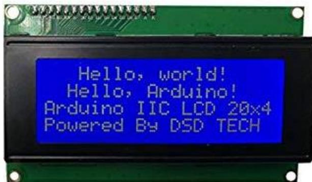
Figura 16. Pantalla LCD 20x4
