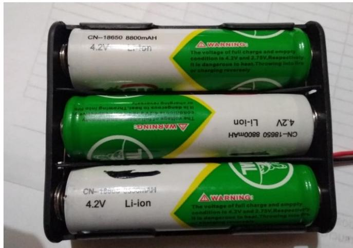
Figura 34. Baterías de Li-Ion 18650
