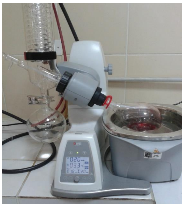
Fotografía 32. Rotavapor eliminando la parte alcohólica del colorante de uva silvestre.
