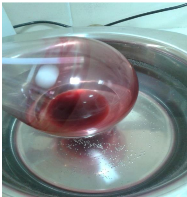
Fotografía 32. Rotavapor eliminando la parte alcohólica del colorante de uva silvestre.
