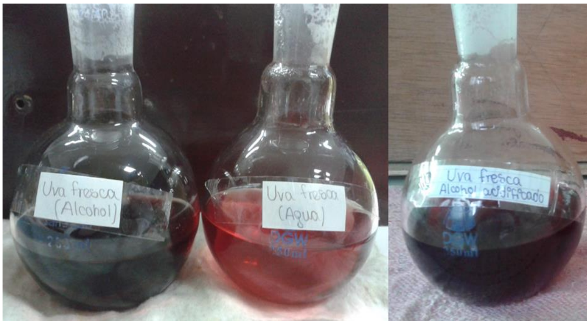
Fotografía 26. Extracto del colorante en soluciones de alcohol etílico, agua destilada y alcohol etílico acidificado (alcohol etílico-ácido cítrico).
