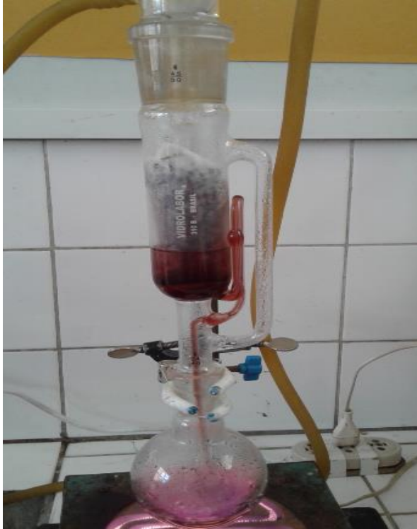
Fotografía 25. Extracción del colorante de uva silvestre por el Método Soxhlet.
