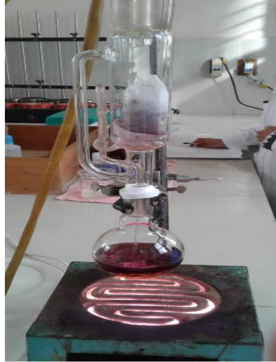
Fotografía 25. Extracción del colorante de uva silvestre por el Método Soxhlet.
