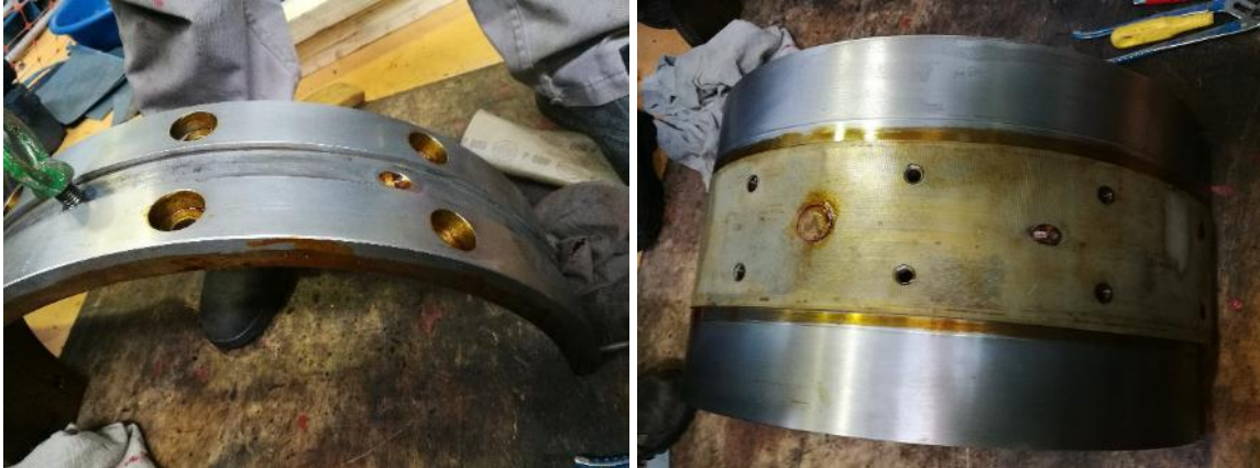
Fotografía 2.3: Semi luna guía y aislamiento de cojinete
