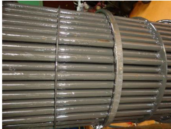
Figura 2.5: Suciedad en el has de tubos lado aceite, intercambiador coraza-tubo
