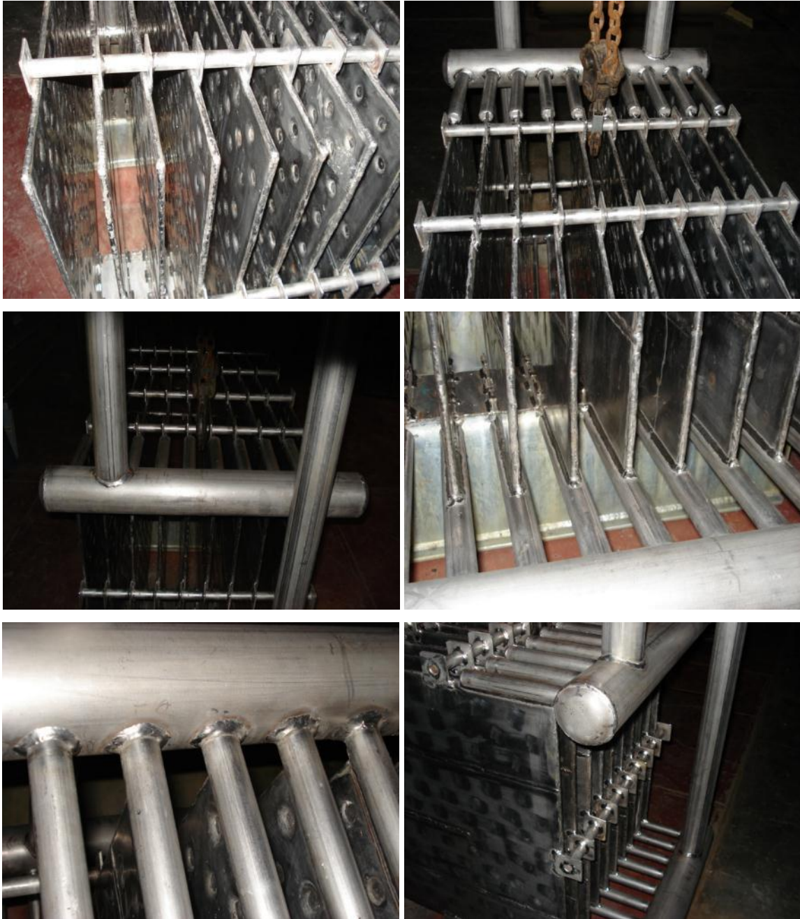
Fotografía. 1, Fabricación del intercambiador de Placas Planas
