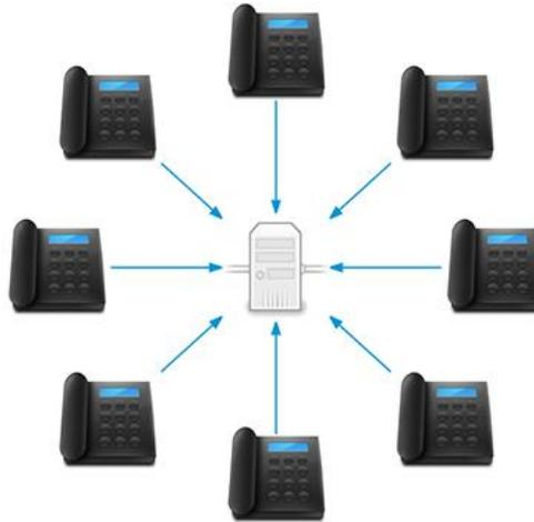
*Figura 2.* Esquema de trabajo de un Servidor SIP Proxy.
